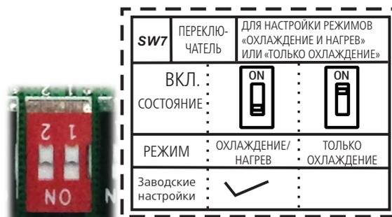
Г. Микропереключатель SW7 предназначен для выбора режима охлаждения и нагрева или режима только охлаждения.
