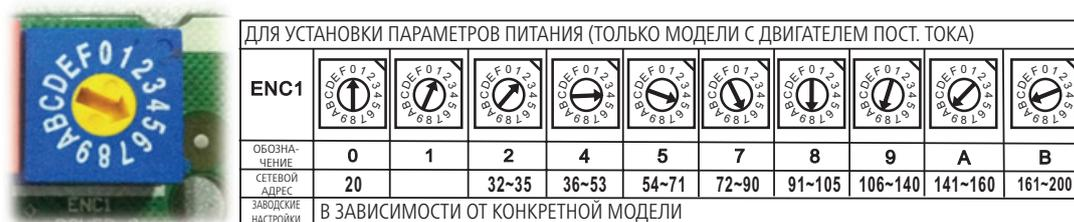
F. Поворотный переключатель ENC1: печатная плата внутреннего блока универсальна и предназначена для всей серии блоков от 7К до 68К. Установка переключателя ENC1 позволяет основной программе определить мощность блока.
