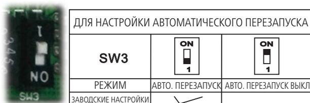
С. Микропереключатель SW3 предназначен для выбора функции автоматического перезапуска. Диапазон значений: активирован, не активирован.
