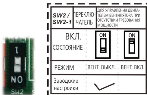
В. Микропереключатель SW2/SW2-1 предназначен для выбора ДЕЙСТВИЯ ВЕНТИЛЯТОРА внутреннего блока, когда температура в помещении достигает заданного значения и компрессор выключается.
