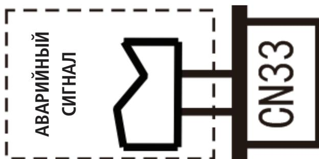
В. Для АВАРИЙНОГО СИГНАЛА служит разъем CN33
