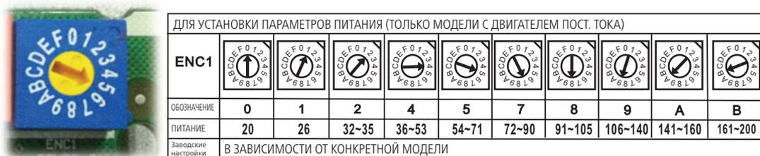
И. Поворотный переключатель ENC1: печатная плата внутреннего блока универсальная и предназначена для всей серии блоков от 7К до 68К. Установка переключателя ENC1 позволяет основной программе определить мощность блока.
