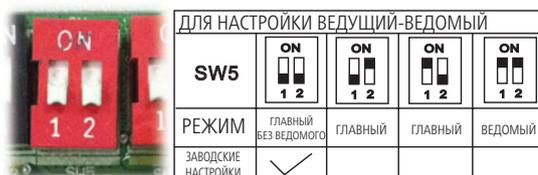
G. Микропереключатель SW5 используется для назначения ведущего или ведомого блока, когда блок находится в парном соединении.
