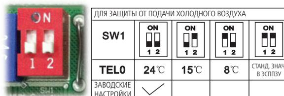
А. Микропереключатель SW1 предназначен для выбора температуры остановки вентилятора внутреннего блока (TELO), когда он находится в режиме предотвращения подачи холодного воздуха в режиме нагрева. Диапазон значений: 24 °С, 15 °С, 8 °С, в соответствии с настройками ЭСПЗУ (зарезервировано для специальных настроек).
