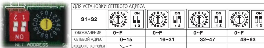
E. Микропереключатель S1 и поворотный переключатель S2 предназначены для установки адреса при управлении блоком с помощью центрального пульта управления.
