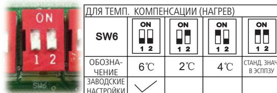
D. Микропереключатель SW6 предназначен для выбора температурной компенсации в режиме нагрева. Это помогает уменьшить реальную разницу температур у потолка и около пола, чтобы кондиционер мог работать нормально. Чем ниже высота установки, тем меньшее значение можно выбрать.
