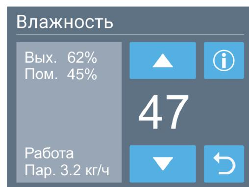
Для изменения температуры, влажности (доступно только при наличии увлажнителя) или скорости вентилятора (может быть недоступно в режиме VAV) нажмите на область, где отображается этот параметр. Откроется новое окно, в котором будет показана заданная
