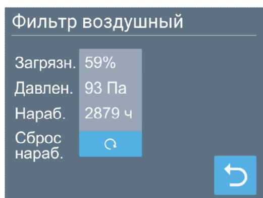
Второй параметр – падение давления на фильтре, измеренное датчиком (зависит от загрязненности фильтра и скорости вентилятора).
