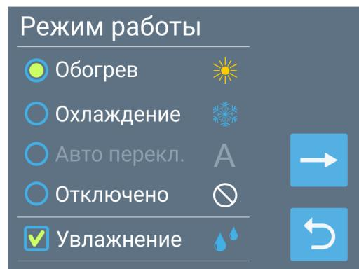
Отдельно включается режим **«Увлажнение»** (при наличии увлажнителя) для поддержания заданной влажности воздуха. При включении этого режима на основном экране появляется соответствующая пиктограмма.
