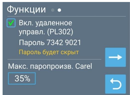
При подключении увлажнителя **Carel** по Modbus будет доступна настройка с заданием его максимальной паропроизводительности в диапазоне от 20% до 100% (если увлажнитель Carel не подключен, то эта настройка будет недоступна).
