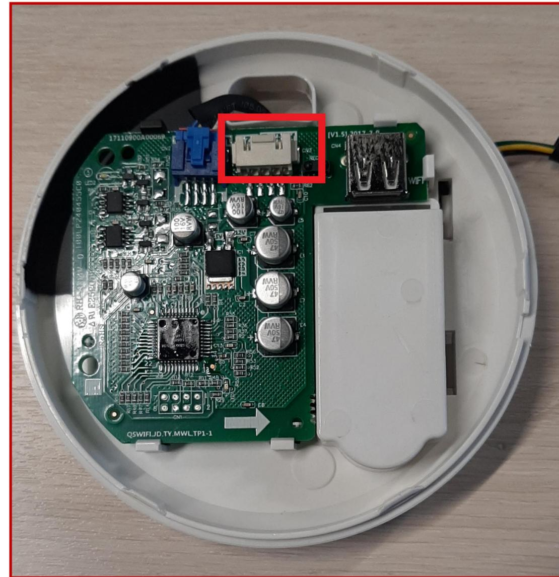
3. Вставьте Wi-Fi модуль в Wi-Fi конвертер
