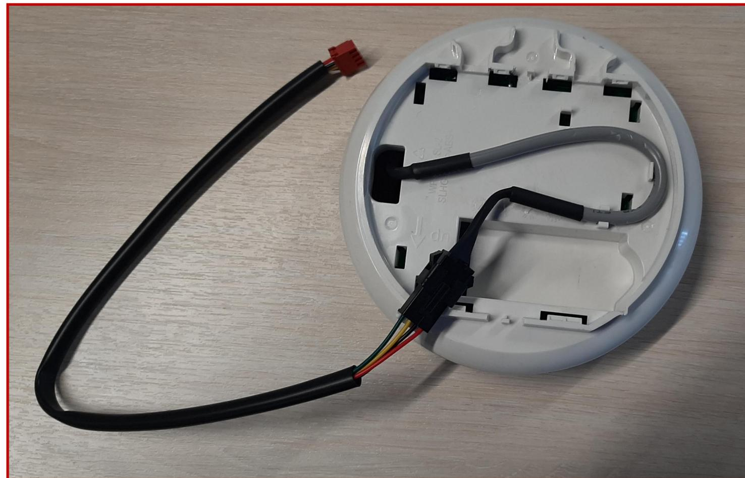
2. Если для дополнительного управления кондиционером требуется подключить пульт KJR-120C, то кабель от ПДУ нужно подключить к разъему, расположенному внутри Wi-Fi конвертера. Для этого аккуратно откройте конвертер и подключите кабель.
