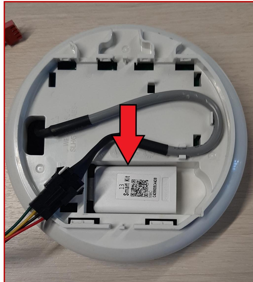
4. Подключите ответную часть кабеля от Wi-Fi конвертера к разъему CN40 (или в отдельных случаях к разъему CN49) на плате управления внутреннего блока.
